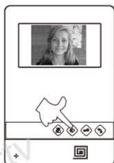
Пока длятся 90 секунд режима мониторинга или интеркома, нажмите кнопку "Разблокировать", чтобы открыть замок, подключенный к этой панели. (Кнопка "Открыть дверь / Звук" открывает дополнительный замок, подключенный непосредственно к монитору).
