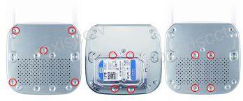
1) Открутите четыре винта, фиксирующих верхнюю крышку, снимите ее. Закрепите жесткий диск на нижней панели с помощью винтов.
